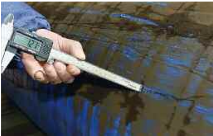
Рис. 9. Замер глубины царапин на образце № 2.
