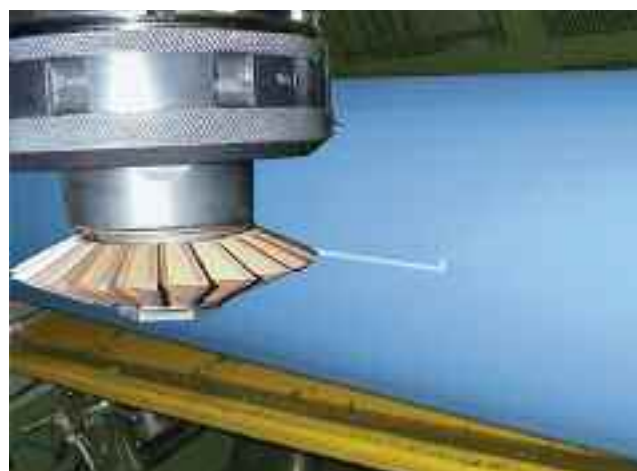
Рис. 3. Лабораторные испытания определения стойкости защитного покрытия к механическим повреждениям методом царапания
