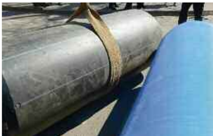
Рис. 6. Общий вид образцов: № 1 – по ГОСТ 18599-2001 (слева), № 2 – труба ПРОТЕКТ с защитным слоем (справа)
