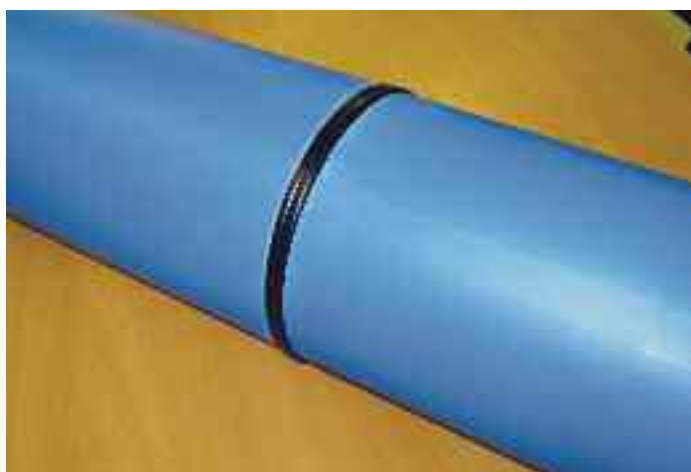
Рис. 11. Сварка встык труб ПРОТЕКТ без удаления защитного покрытия. Внешний вид
