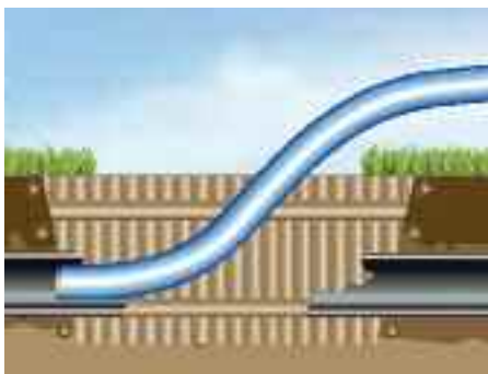
б) релайнинг (протаскивание трубы в трубу)
