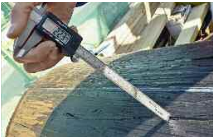
Рис. 8. Замер глубины царапин на образце № 1.
